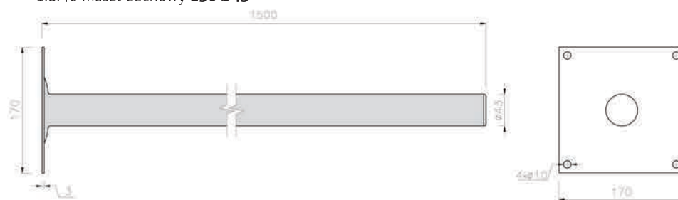
1.8.40 maszt dachowy 150 \varnothing 43
